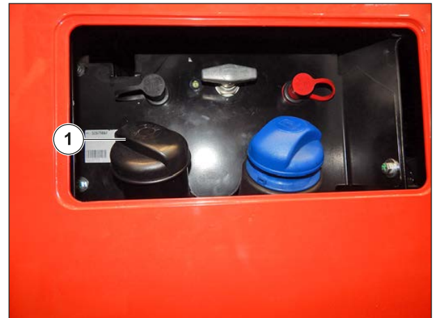
Figura 121: Umplerea rezervorului de combustibil
