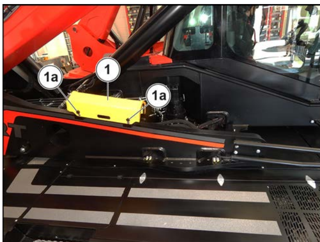
Figura 210: Pană de siguranță a brațului
