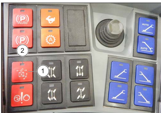
Figura 133: Buton de resetare a sistemului de siguranță a călătoriei
