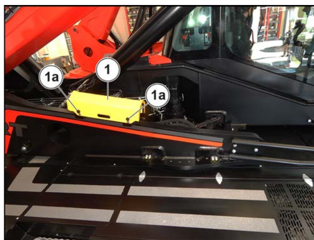
Figura 67: Pană de siguranță a brațului
