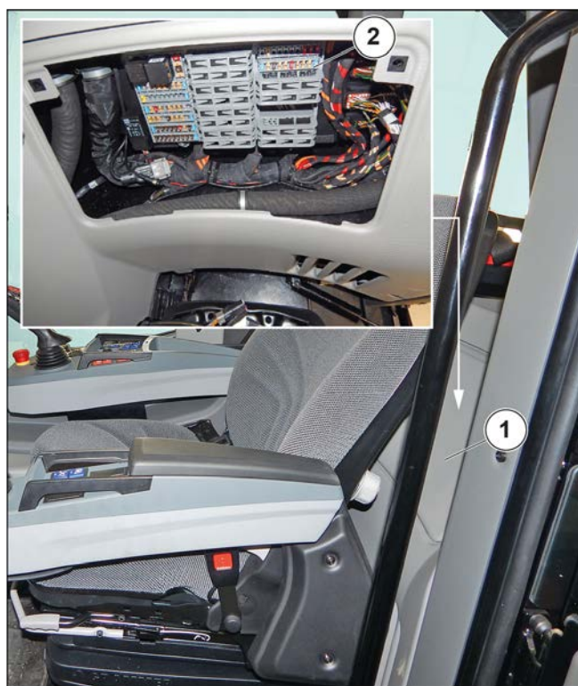
Figura 214: Siguranțe și relee în cabină
