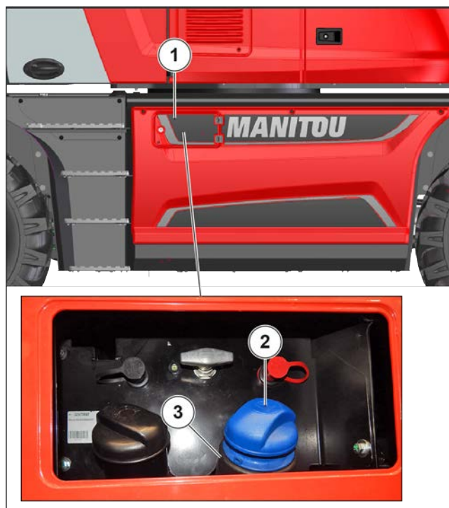
Figura 149: Verificarea nivelului de lichid DEF
