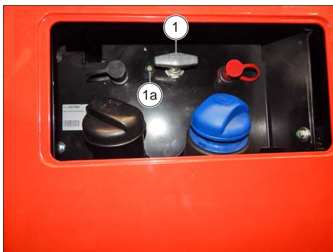
Figura 66: Comutator de deconectare a bateriei
