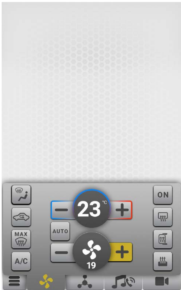
Figura 80: Buton încălzire și aer condiționat (opțional)
