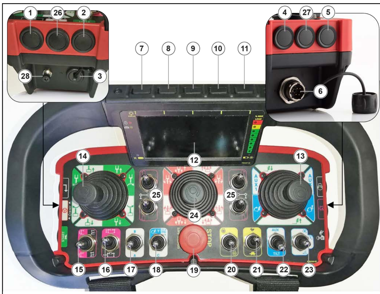
Figura 119: Panoul cu butoane de comandă al unității emițătorului
