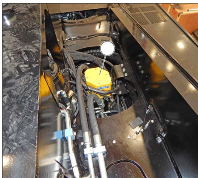
Figura 224: Verificarea și curățarea inelelor emițătorului pentru colectorul electric rotativ
