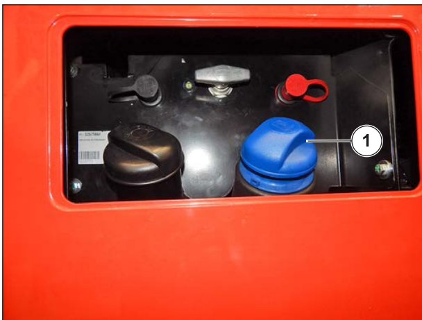
Figura 122: Umplerea rezervorului „DEF”
