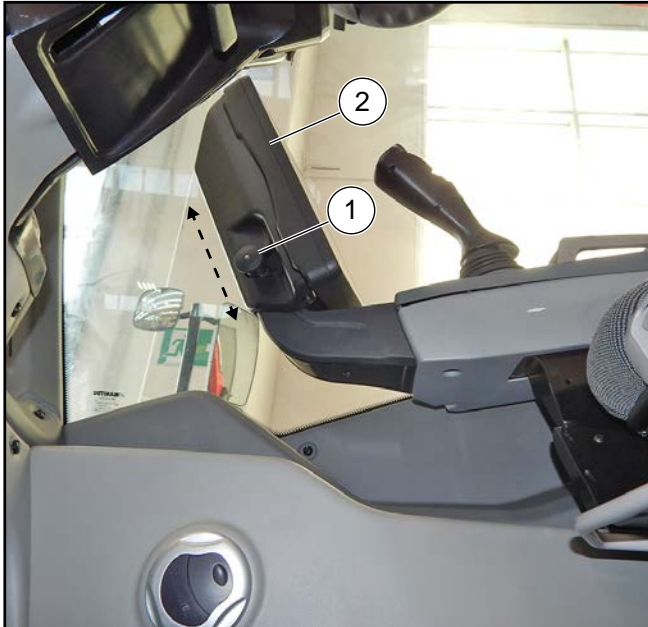
Figura 56: Buton de reglare a înălțimii afișajului
