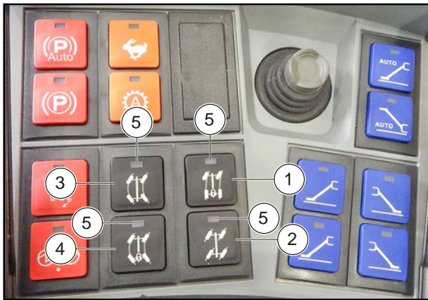
Figura 129: Modul de direcție
