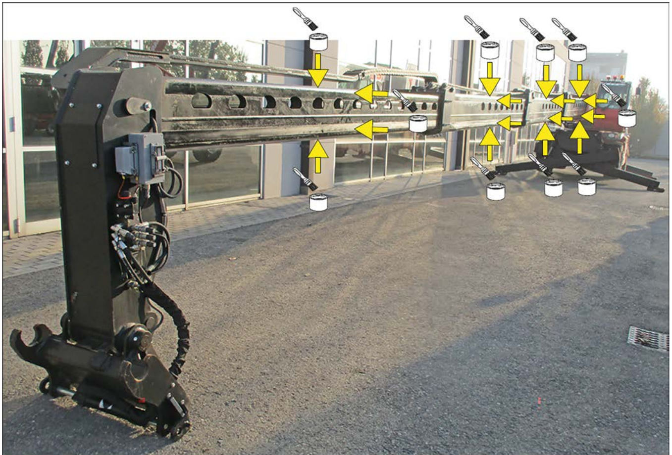
Figura 156: Curățarea și lubrifierea saboților brațului telescopic
