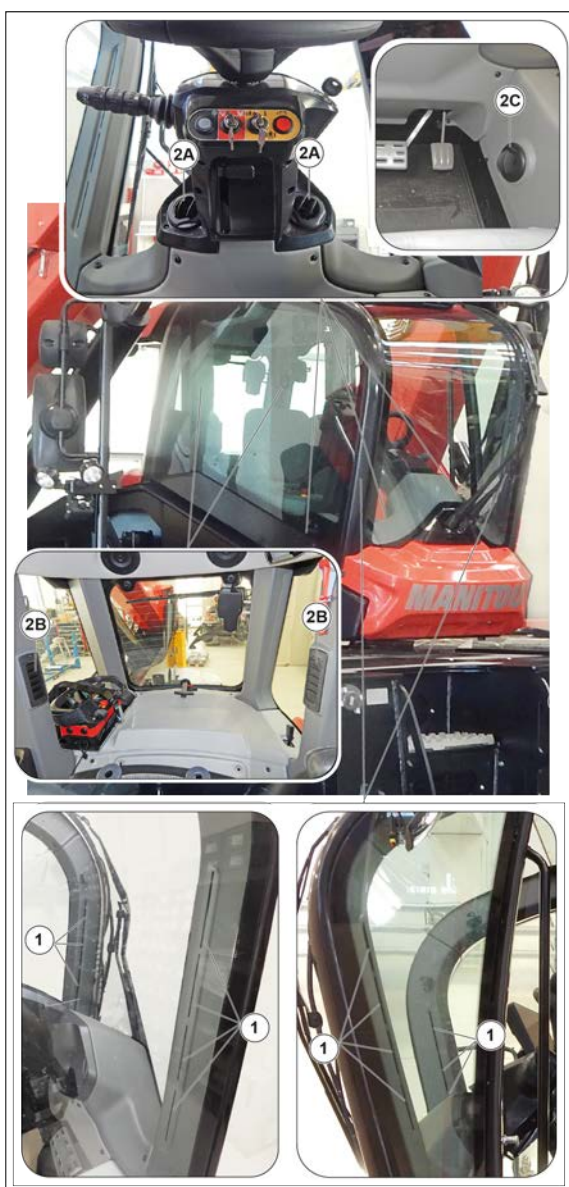
Figura 62: Difuzoare pentru dezaburire și orificii de ventilație pentru încălzire
