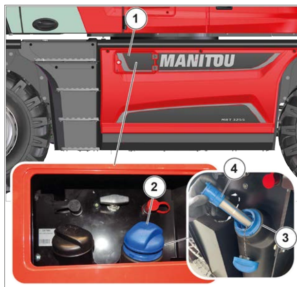
Figura 226: Verificarea și curățarea filtrului de umplere a rezervorului def
