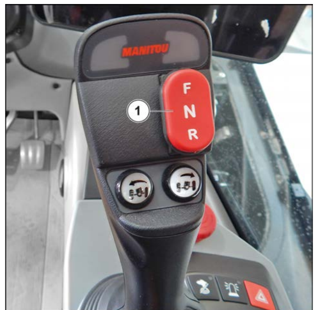
Figura 132: Folosirea selectorului FNR
