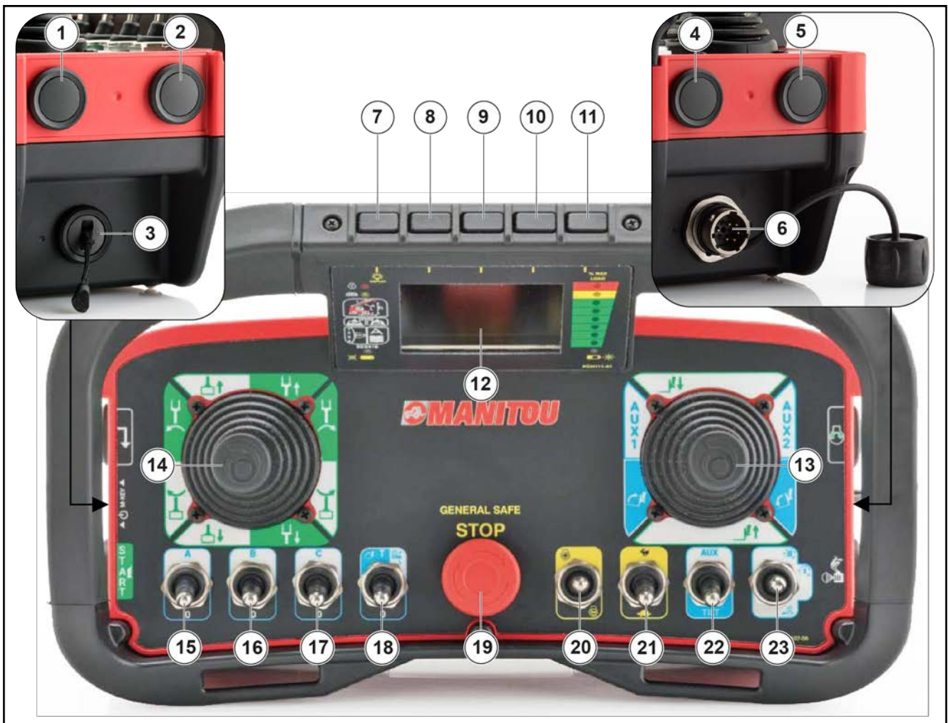
Figura 110: Panoul cu butoane de comandă al unității emițătorului
