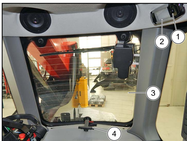
Figura 58: Lumina plafonului și manetă de deschidere a lunetei
