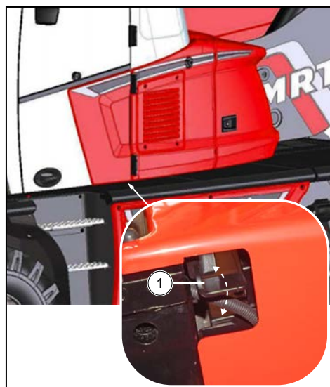
Figura 61: Maneta de eliberare a geamului ușii din afara cabinei
